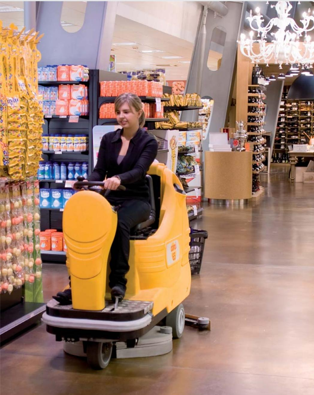
Kompakter Aufsitz-Scheuersaugautomat der 24Volt Klasse. Die dickschichtigen Polyäthylentanks fassen 100 Liter Reinigungslösung.
